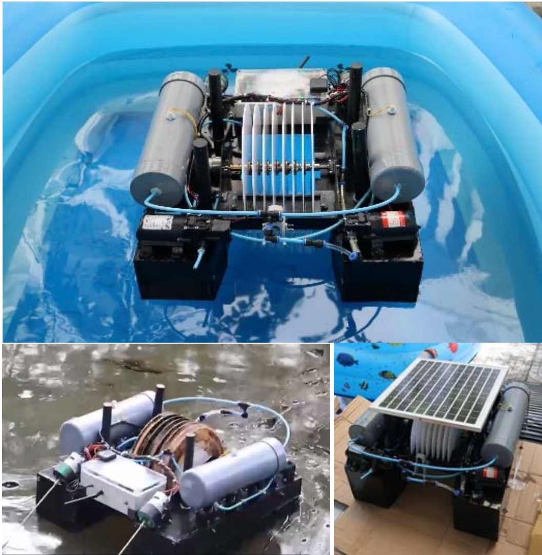
Hình 2. Vận hành thử nghiệm Robot lọc vớt dầu chạy bằng năng lượng mặt trời
