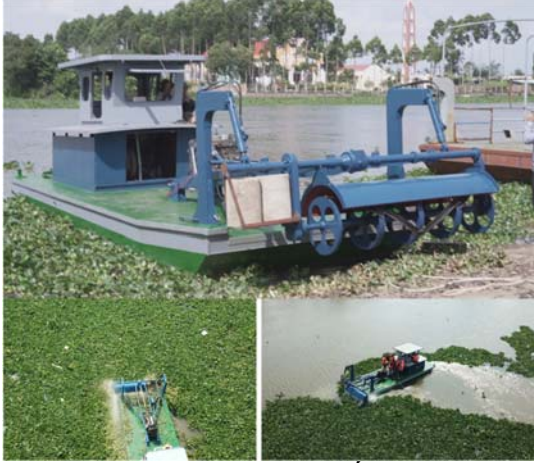
Hình 14. Mô hình thực nghiệm lắp đặt trên phao nổi.
