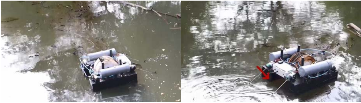
Hình 3. Vận hành thử nghiệm Robot lọc vớt dầu chạy bằng năng lượng mặt trời trong điều kiện thực tế
