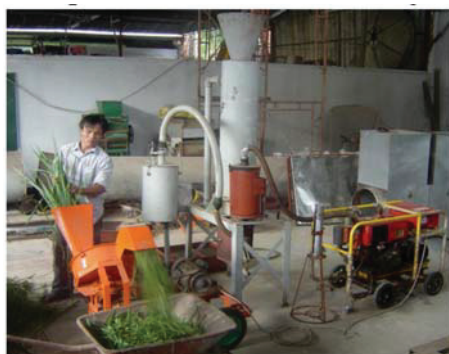
Hình 7. Hệ thống hóa khí liên hợp với máy thái cỏ voi và kết quả khảo nghiệm [5]
