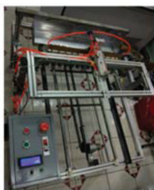
a. Khâu gieo hạt tưới b. Cơ cấu định vị tọa độ tự động Hình 6.5. Thiết bị chăm sóc cây trồng trên khay tự động
