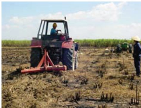
Hình 4 & 5. Cày ngằm phá gốc mía tại La Ngà và được cải tiến để chăm sóc cây cao su
