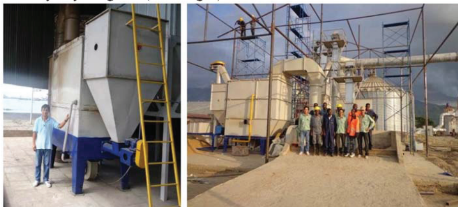
Hình 4. Lò đốt trấu tự động được lắp vào hệ thống sấy [3]
