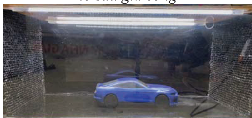
Hình 5.2 Lắp thêm đèn led trong buồng thử
