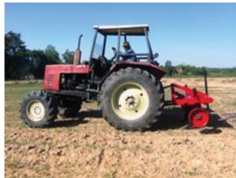
Hình 4 & 5. Cày ngằm phá gốc mía tại La Ngà và được cải tiến để chăm sóc cây cao su
