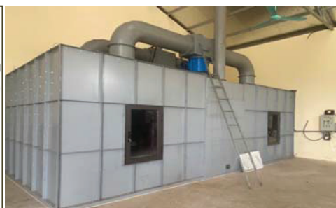
Hình 2. Nguyên lý (trái) và hệ thống thiết bị (phải) sấy sử dụng năng lượng gián tiếp từ sinh khối
