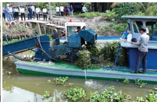
Hình 17: Vận hành thử nghiệm tổ hợp thiết bị máy cuộn lục bình tại khu vực huyện Mộc Hóa, tỉnh Long An.
