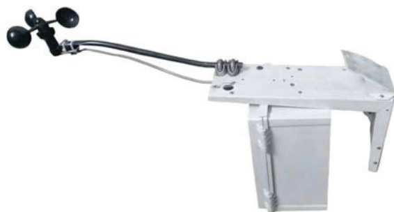
Hình 3. Thiết bị đo và ghi số liệu vận tốc gió tự động lắp trên trụ của tuabin
