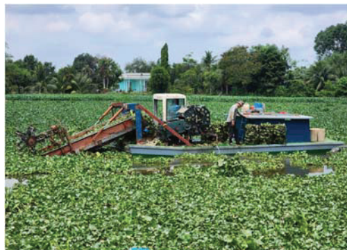
Hình 16: Thiết bị đóng cuộn lục bình vận hành thử nghiệm trong môi trường lục bình dày đặc.
