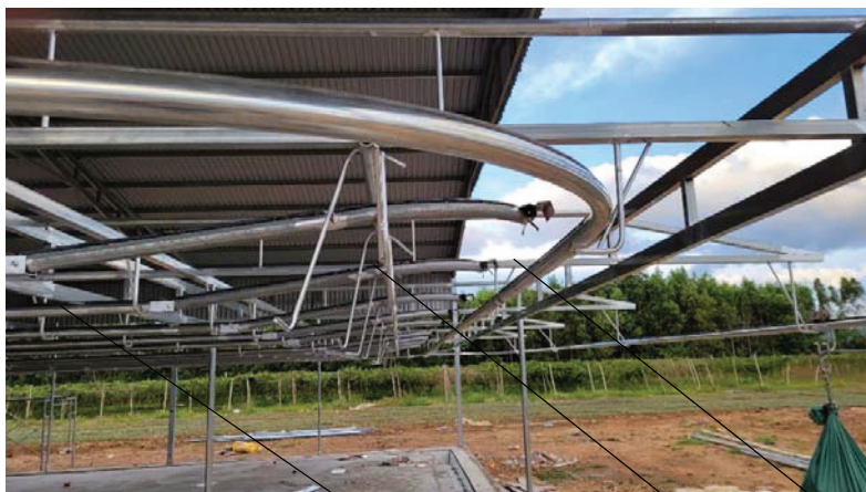
Hình 1. Hệ thống chuyển làn trong nhà sơ chế 1. Đường ray chính; 2. Cơ cấu chuyển hướng; 3. Đường rẽ nhánh
