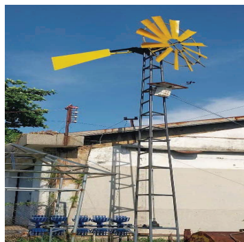
Hình 12. Tuabin gió được lắp đặt và khảo nghiệm cùng với cánh khuấy
