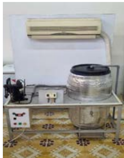
Hình 3. Mô hình thí nghiệm hệ thống bơm nhiệt đun nước nóng
